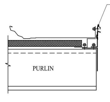
FASTEN PANEL TO SLIDING TAB OF SSR CLIP USING 2) 1/4-14 x 3/4" STITCH SCREWS PER CLIP.
